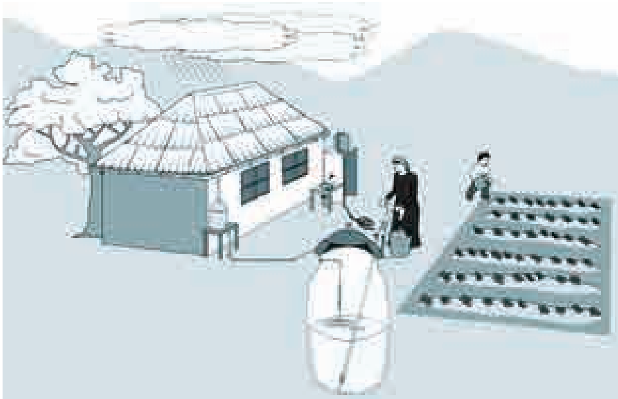
Система водоснабжения при сборе дождевой воды для домашнего хозяйства ( www.emas-international.de )
