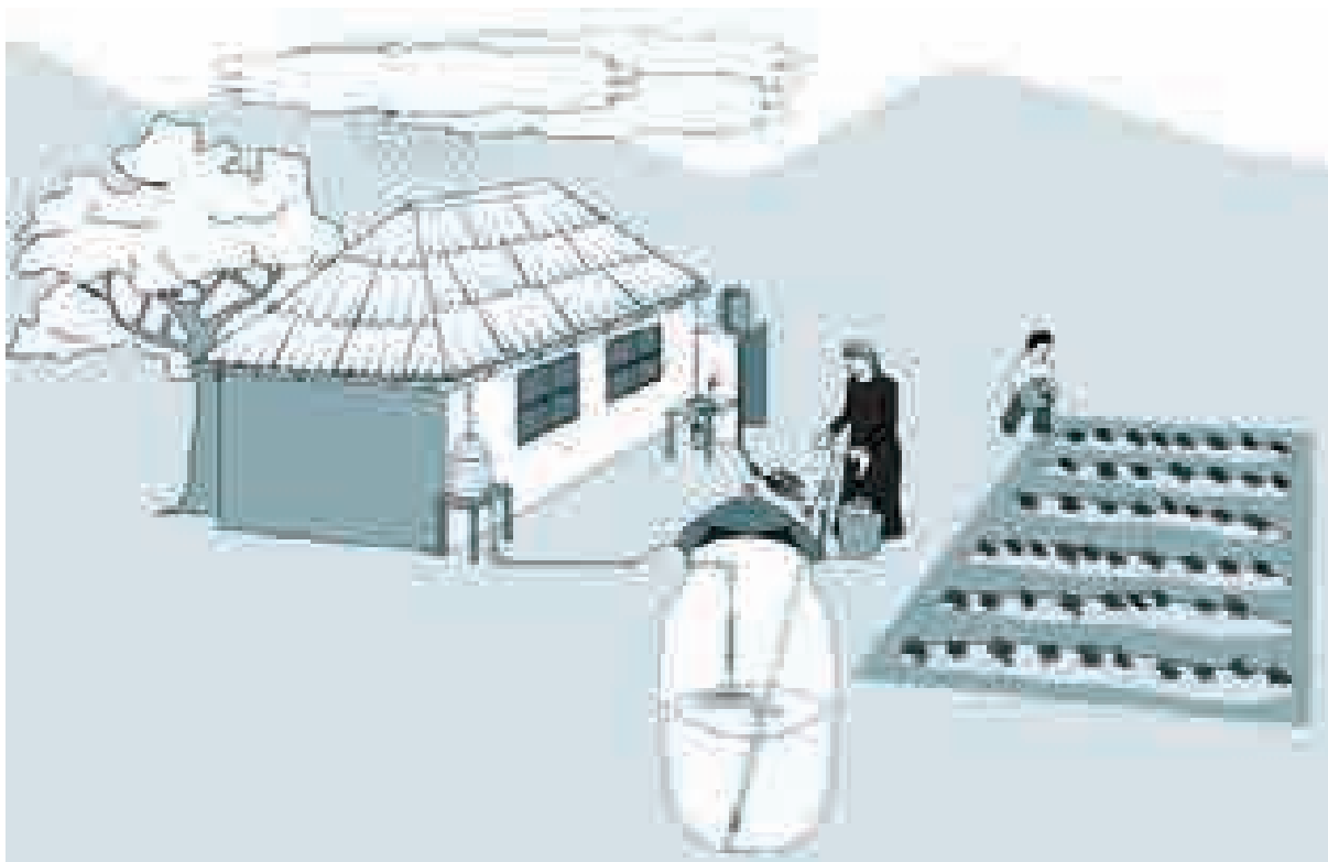
Жамгыр сууларын топтоо аркылуу үй тиричилигин суу менен камсыздоо системасы ( www.emas-international.de )
